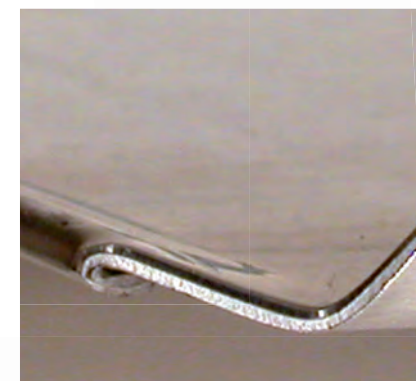
Stabilität durch Ankantung
